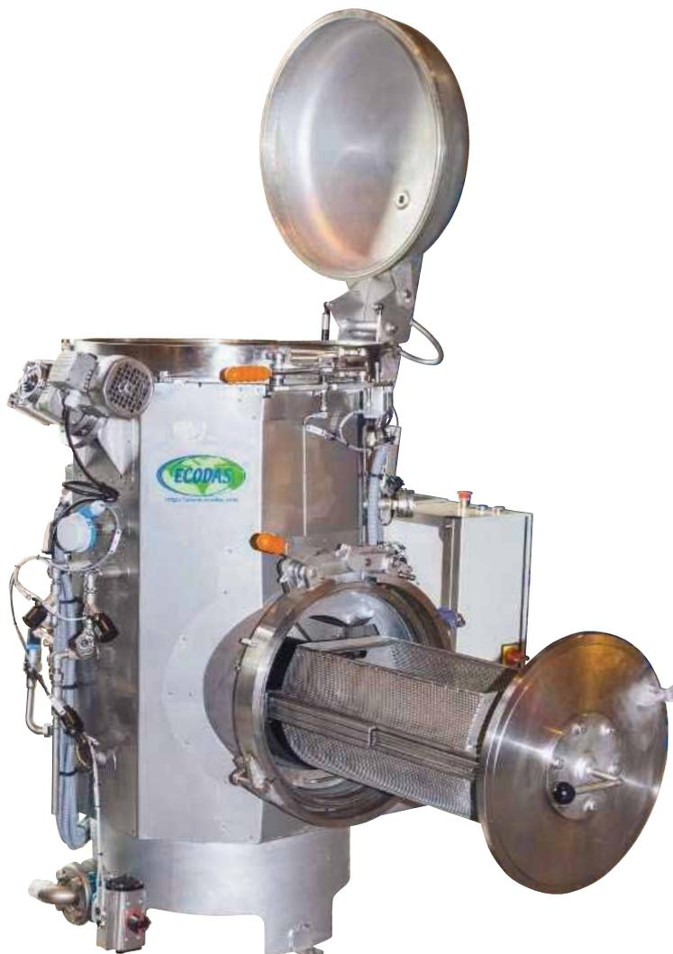
Les déchets contaminés sont introduits dans la chambre supérieure de la machine munie d'un broyeur à haute résistance. Les déchets sont broyés et acheminés, par gravité, vers la chambre inférieure.
